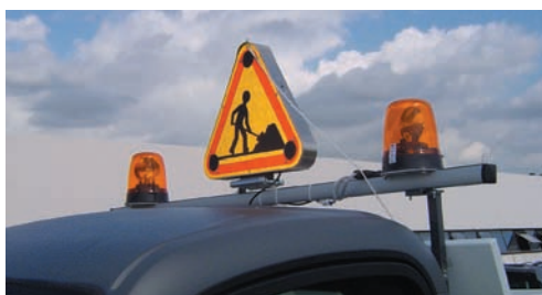
Verkeersbord 'werkzaamheden' met twee zwaailichten
